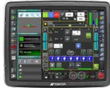
Toutes les commandes de la cellule **GREGOIRE ISO Ultima** sont accessibles depuis l'écran **i-Monitor**. Le **débit produit** est régulé automatiquement par le système **DPAE**, garantissant une application constante et précise.
