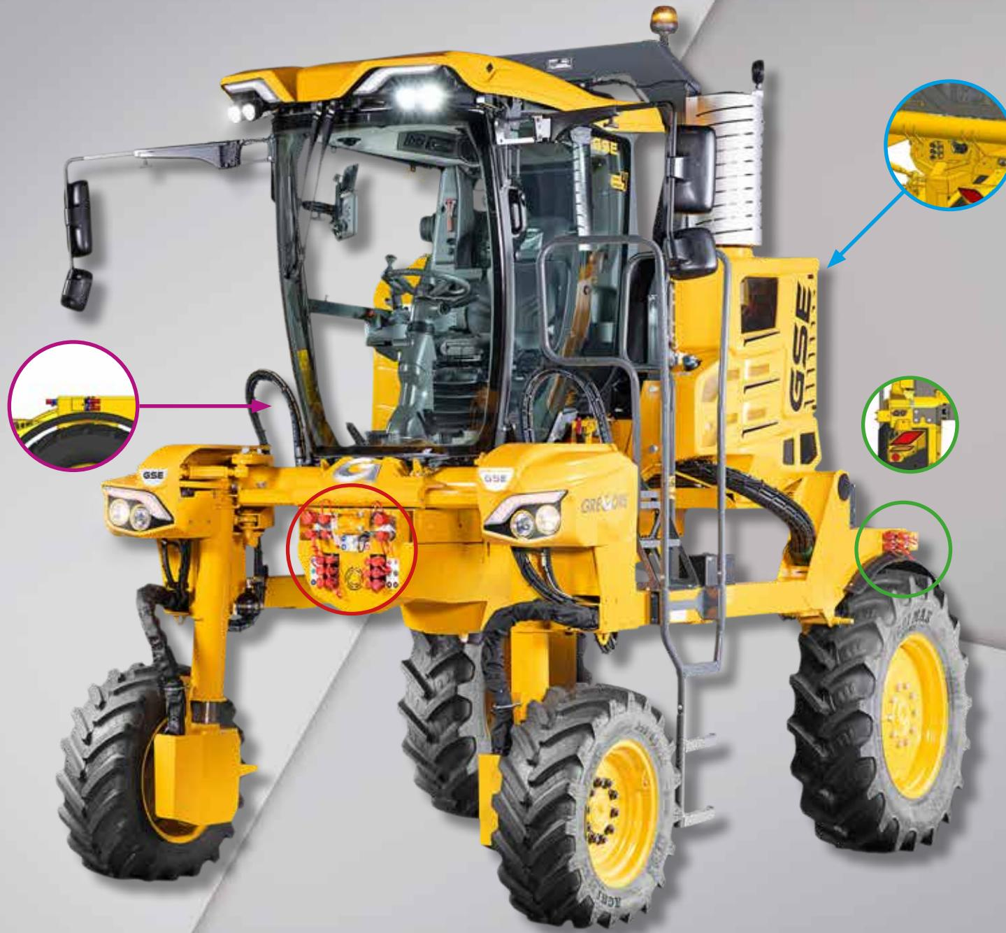
**GREGOIRE GSE** est équipé d'un circuit hydraulique en **Flow Sharing**, une exclusivité dans le segment de la vigne étroite. Les outils bénéficient ainsi en permanence d'un débit et d'une pression d'huile optimaux, garantissant précision et fluidité de mouvement.
