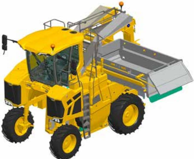
La **benne centrale inox GREGOIRE** offre la plus grande capacité de stockage de sa catégorie. Son positionnement central assure un équilibre optimal et une visibilité accrue sur la récolte. Le système de porte hydraulique permet un **contrôle total du vidage**, y compris partiel, sans quitter le rang. Une rallonge de benne est disponible pour les rangs les plus larges.
