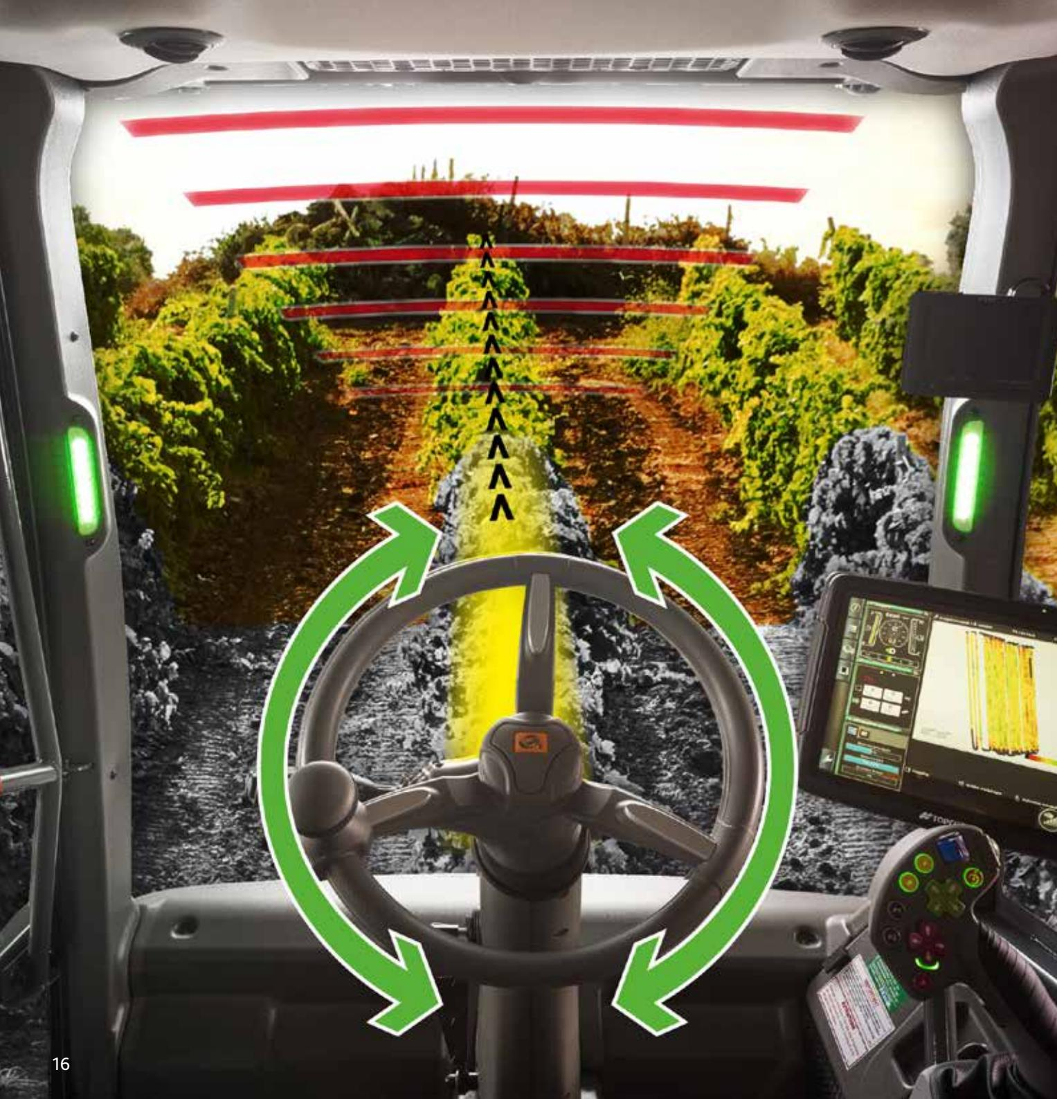
La cabine centrale des porteurs **GREGOIRE GM, GL et GX** assure un **alignement parfait sur le rang**. La surface vitrée panoramique offre une visibilité totale à 360°, et le **plancher vitré** permet un contrôle précis de l'entrée de la vigne dans le tunnel de récolte comme du positionnement du porteur.
