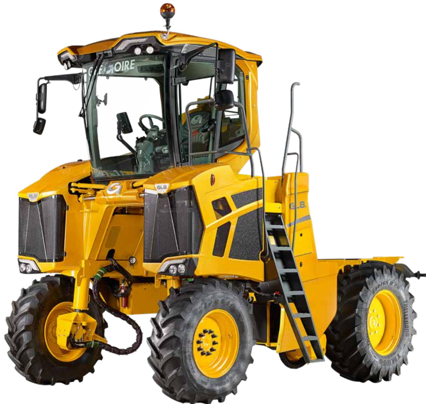
La tractora es la columna vertebral de la vendimiadora. Comprende todos los sistemas y controles de la máquina (motor, controles, cabina,...).
