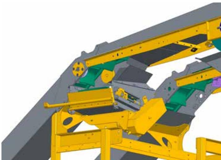
de las tolvas. La zona de descarga (rampas o cintas secundarias, según versión) es accesible desde la pasarela superior para facilitar su regulación y limpieza. El movimiento de las cintas se genera mediante un sistema de poleas motrices provistas de un mecanismo de auto tensado que mantiene de forma automática la tensión correcta en las cintas.
