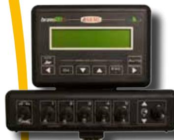
Le système DPAE (option)(Débit Proportionnel à l'avancement Electronique) régule automatiquement le débit en fonction de la vitesse d'avancement. La dose est maintenue quelle que soit la topographie du vignoble. Les entrées et les sorties de rangs peuvent se faire en douceur.
