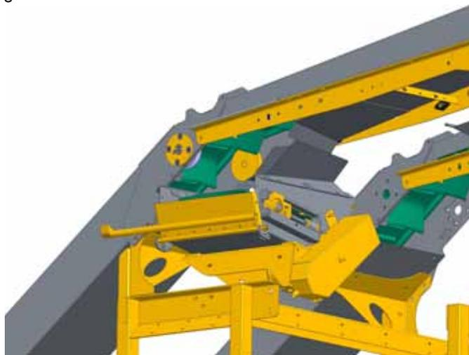
Le versioni a 4 aspiratori o il sistema di diraspamento **EASYclean** di **GL7** e **GL8** ricevono da nastri secondari. La grande larghezza dei trasportatori secondari (4 aspiratori: 500 mm - **EASYclean**: 380 mm) migliora la maneggevolezza e la distribuzione del prodotto per una pulizia ottimizzata.
